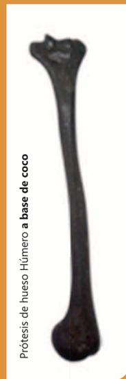
Para la creación del hueso se tomaron 1,7 kilos de coco procesado y se realizó la mezcla con polímeros, unión de moléculas para lograr mejor adhesión del material. Un hueso húmero real tiene un peso total de 2,5 kilogramos, mientras el de cáscara de coco, pesaría sólo media libra.
